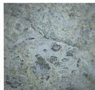
微細クラックを閉塞したRCガード(1000倍)
