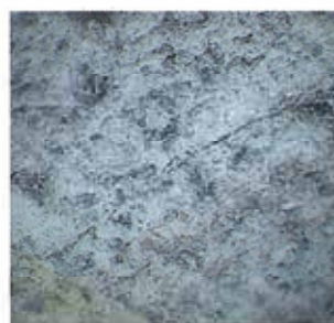
微細クラックの拡大写真(1000倍)
