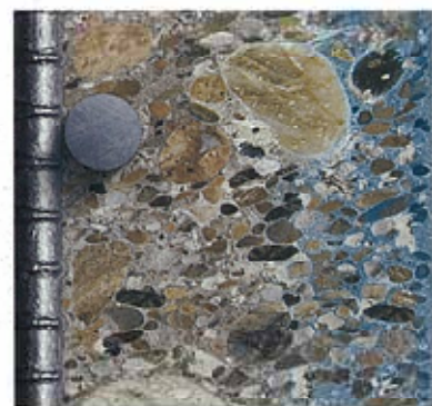
RCガード含浸 RCガードがコンクリート内部に水と一緒に浸透し、水酸化カルシウムと反応。
