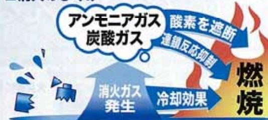
アンプルが割れて消火薬剤が飛び散ると、熱によって消火薬剤から消火ガスが発生し、消火します。
